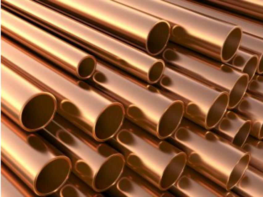
Kupfer hat als einzigstes Metall eine rote Farbe. Nach Silber ist Kupfer der beste Leiter für Wärme und Elektrizität. Gegen Einflüsse ist dieses Metall sehr widerstandsfähig. An der Luft findet bei Kupfer langsam eine Oxidation statt. Die Oberfläche wird rötlich, das heißt dunkler.
